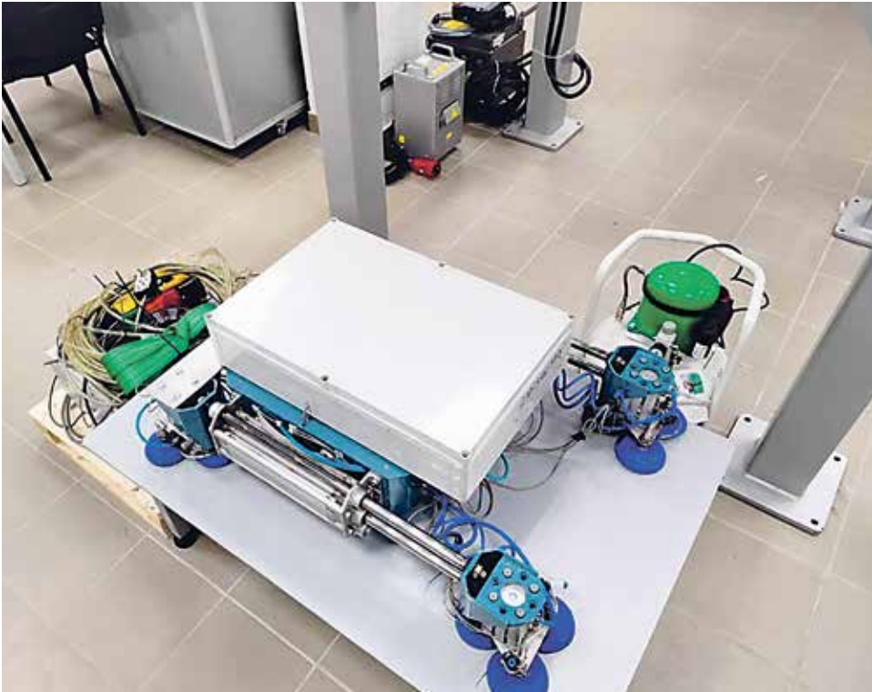
Робот, разработанный в СПбГМТУ, может перемещаться как по надводной, так и по подводной части корпуса судна
