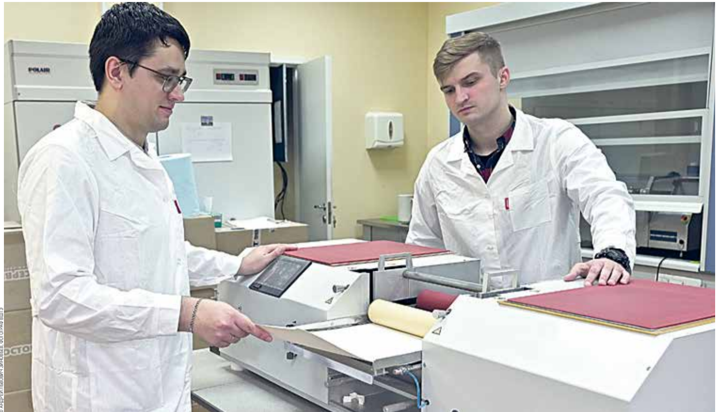
Уникальная установка для нанесения поверхностных покрытий на бумагу и картон
